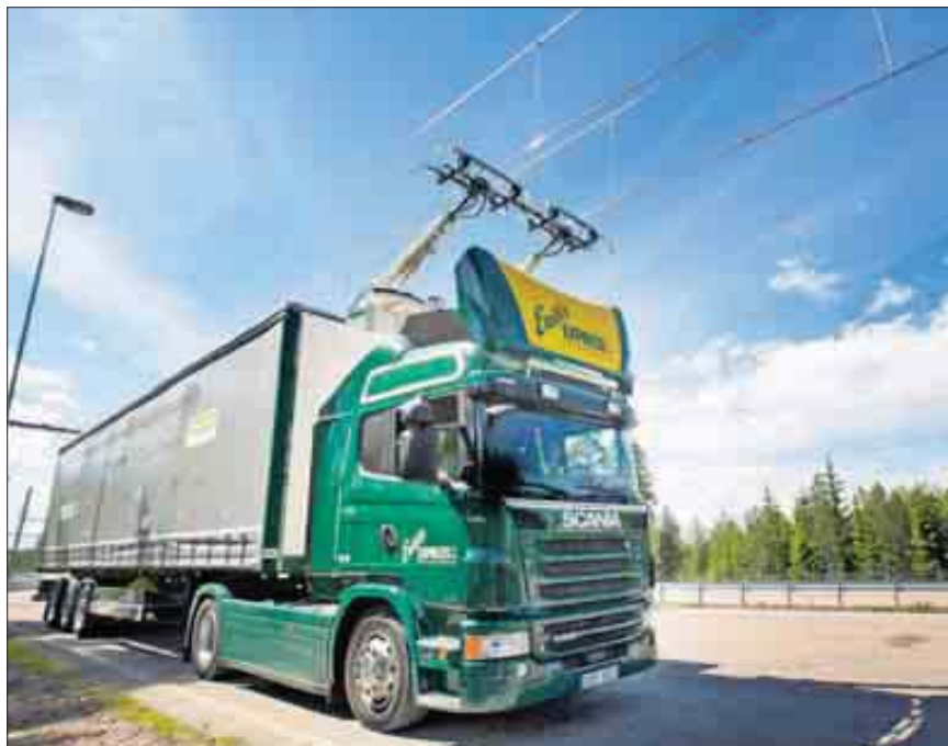
Der schwedische Spezial-Lastwagen von Scania ist mit einer Vorrichtung für den Betrieb mit elektrischen Oberleitungen ausgestattet. Ein solcher Lastwagen könnte ab 2019 auch auf der Teststrecke zwischen Weiterstadt und Langen zu sehen sein. scania-foto
